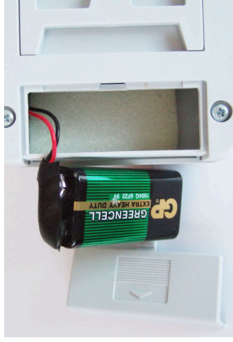
Batteriefach und Anschluß der Batterie
