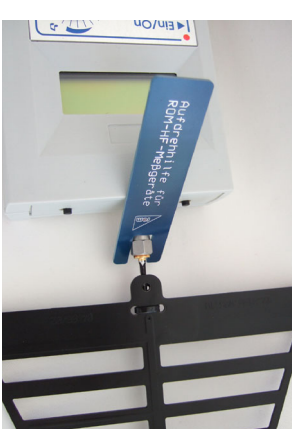
Montage der Antenne mit Aufdrehhilfe
