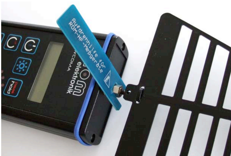
Demontage der Antenne mit Aufdrehhilfe
