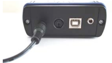
Anschluss Ladegerät an Frequency Master IV
