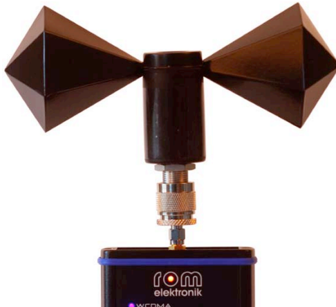
Frequency Master IV mit bikonischer Antenne für den Frequenzbereich von ca. 50 MHz bis 3 GHz
