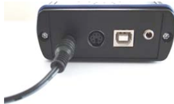
Anschluss Ladegerät an Frequency Master IV
